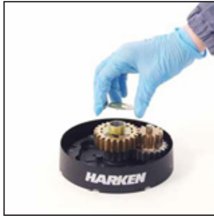
12. Remove the washer n°12
